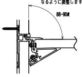
欄板を可動させる時は、セットの時と同様両手で 欄板を斜めにして移動させてください。
