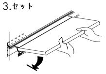
欄板を斜めにして、出っ張り部分をレールの溝に押し込み、 欄板が水平になるまで降ろします。
