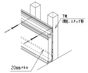
見切レール下部に † 20のパネルを差し込みます。次に 棚受けレール取付位置確認後、パネルがきちんと奥まで 差し込まれている事をご確認下さい。下穴を空けてから 図に従い取付ねじで固定します。
