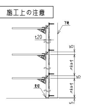
取付パネル: 幅1820mm 高さ105~450mm 厚み20mm パネル寸法は上記寸法を参考に製作してください。
