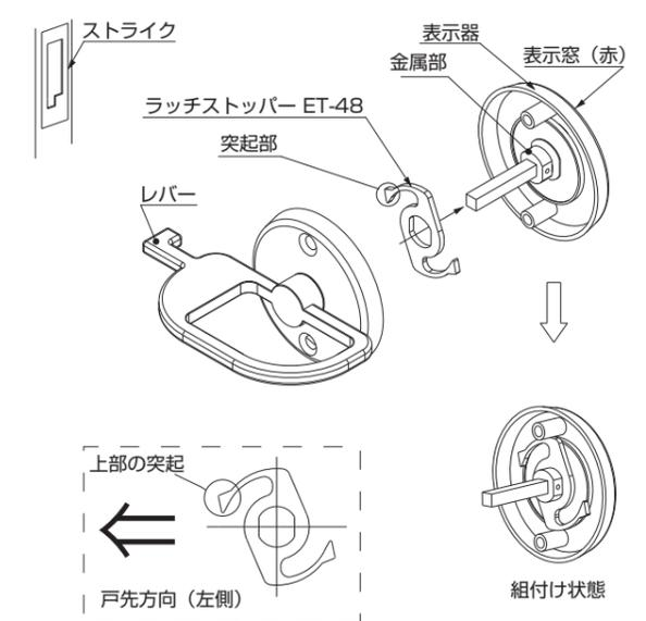
\*左ロック仕様の場合は上部の突起が必ず戸先方向(左側)に向くようにセットしてください。
