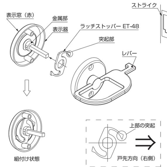
\*右ロック仕様の場合は上部の突起が必ず戸先方向(右側)に向くようにセットしてください。
